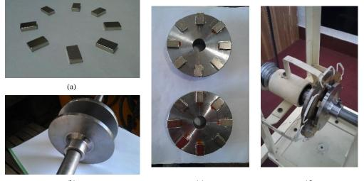
(d) (b) (c)  $Figure \ 7. \ Neodymium \ permanent \ magnets (b) \ Rotor \ plates (c) \ Rotor \ discs (d) \ Complete \ AFPMG \ model.$
