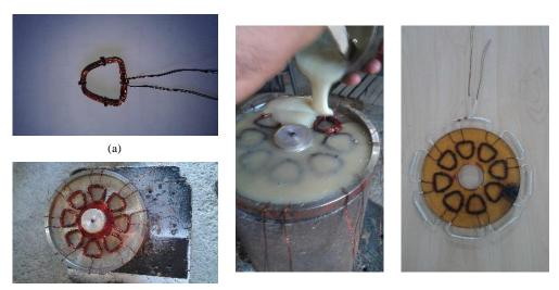
(b) (d) (c) Figure 6. (a) Coil(b) & ator disc template (c) Stator disc casting, (d) Stator disc.
