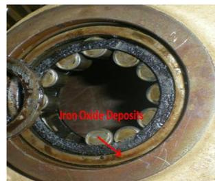
(d) Deposition of FeO on Roller Bearing
